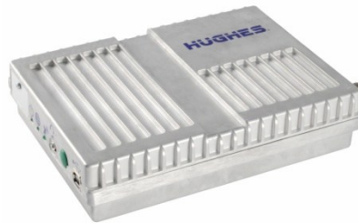
Figure 2: IDU P/N 3500563-0004, -0006, -0009, or -0014
